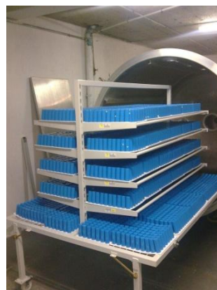
Traitement de pièces PA66 sur plateau thermoformé
