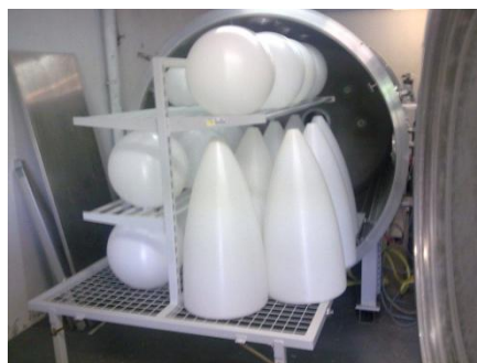
Traitement de sphères (Ø400) et d'ogives (Ø400 -h1000) en PE
